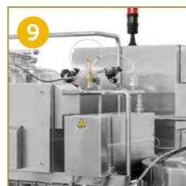
SISTEMA DI RISCALDAMENTO ELETTRICO PER LA PRODUZIONE DI ACQUA SURRISCALDATA (*)
