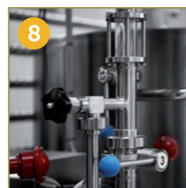
REGOLAZIONE FILTRAZIONE CON VALVOLA MICROMETRICA E SPECOLA VISIVA
