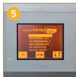
PLC PER LA GESTIONE AUTOMATICA DEL PROCESSO DI PRODUZIONE E LA MEMORIZZAZIONE DI RICETTE
